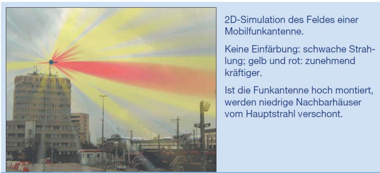
Bild 7: Zum besseren Verständnis zur Strahlungscharakteristik eines Senders hier ein Sendekeulen-Bild eines Mobilfunksenders.
